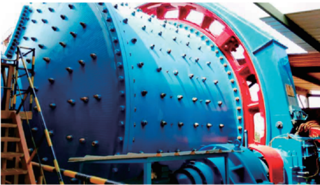
▶ 云南锡业集团某锡矿半自磨机专用高压变频系统
